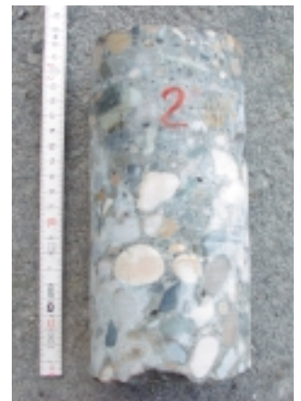
Carotte pour l'inspection du passage inférieur de Wavre. Kontrollbohrkern, Unterführung Wavre.
