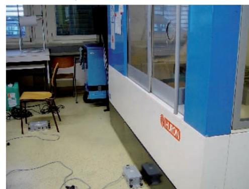
Mesures des vibrations induites par une machine CNC.
