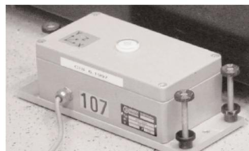
Capteur de vibration: VIBRAS
