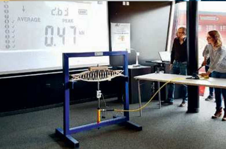
Modèles de ponts créés par des apprentis et test de résistance.
